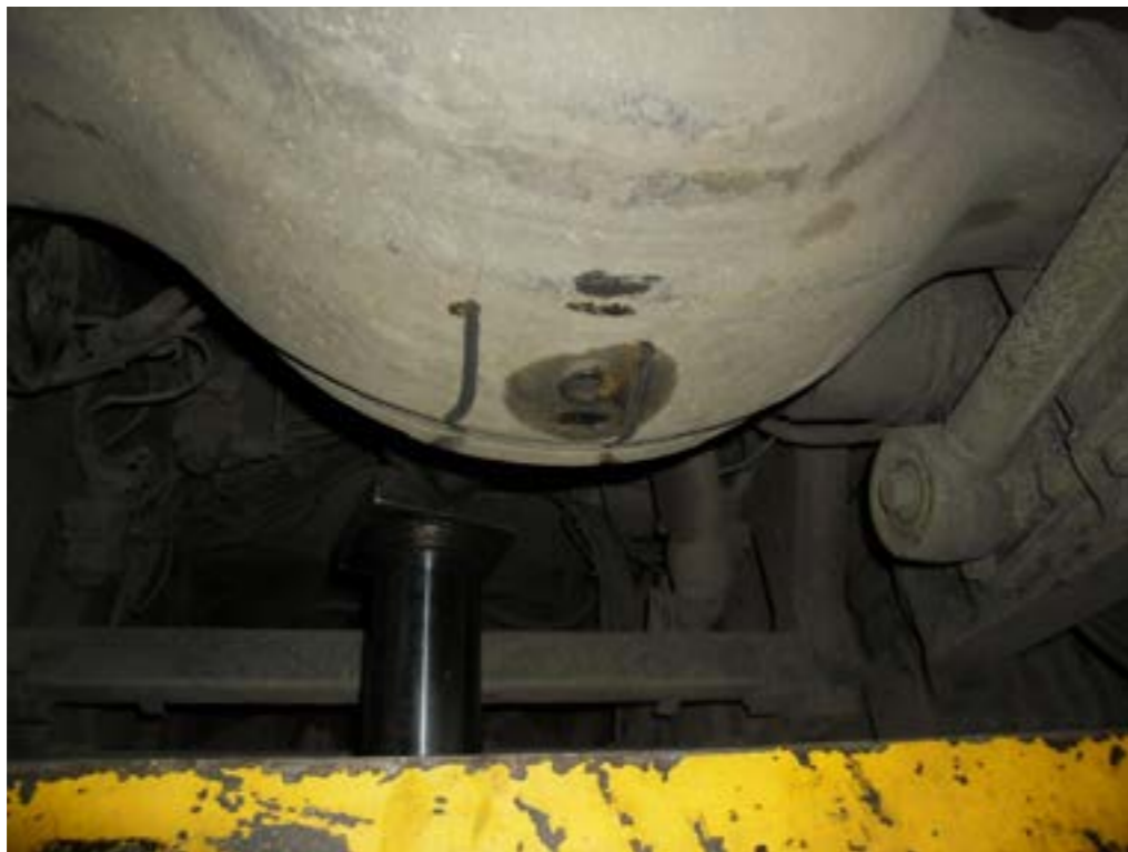
5. kép A szerelőaknában elhelyezett aknaperem emelő emelőfejének elhelyezkedése az emelőpont mellett, valamint a kilökődése által a differenciálműn okozott sérülési nyomok. (munkavédelmi hatóság felvétele)
