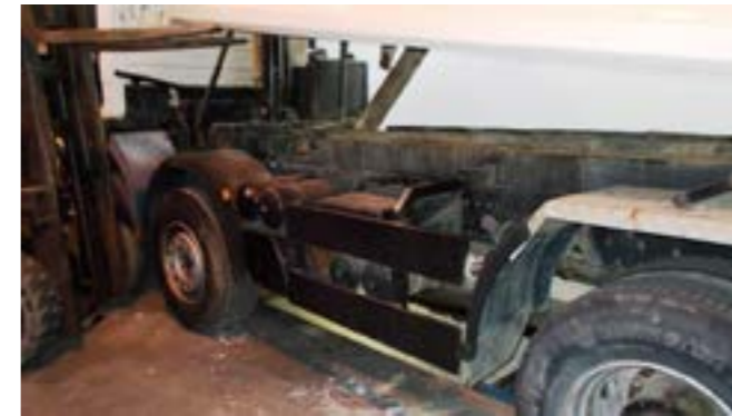
6. kép Baleset után a billenőplatót targoncával emelték meg és támasztották alá (munkavédelmi hatóság felvétele)
