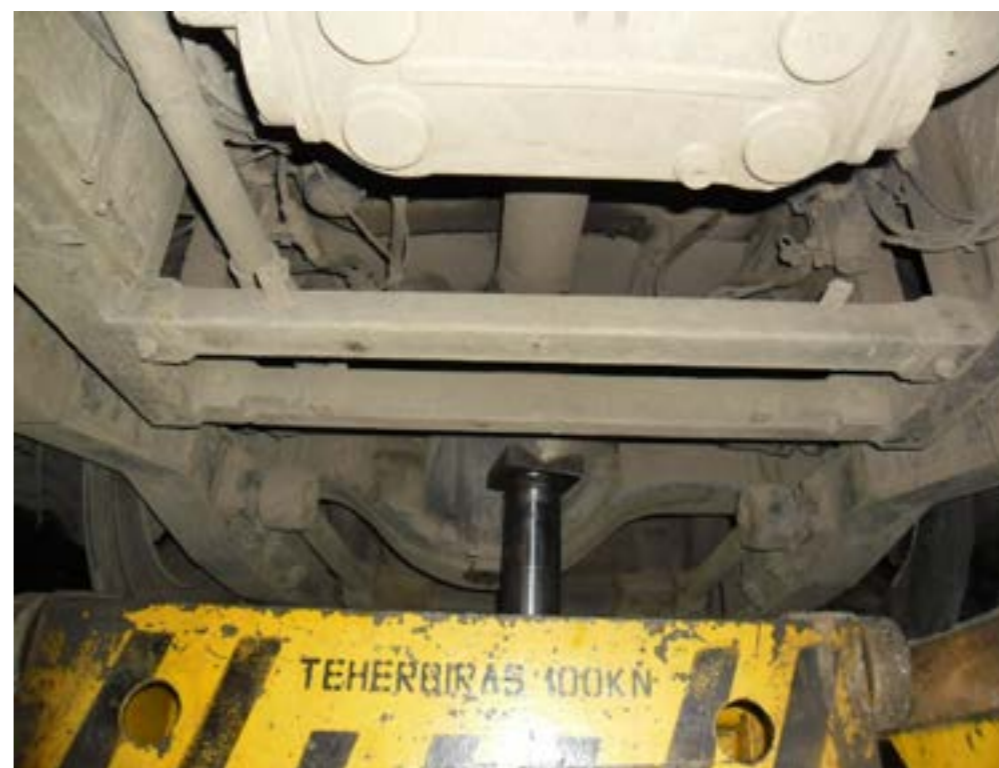
4. kép A szerelőaknában elhelyezett aknaperem emelő emelési ponthoz helyezése. (munkavédelmi hatóság felvétele)
