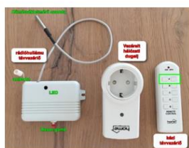
Tűztér hőmérséklet érzékelő – pl. kandalló és konyhai szagelszívó együttes üzemének tiltására
